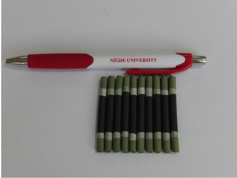
Ekstrüzyon ve sinterleme ile üretim
