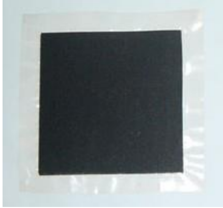
PEM membran elektrot grubu
